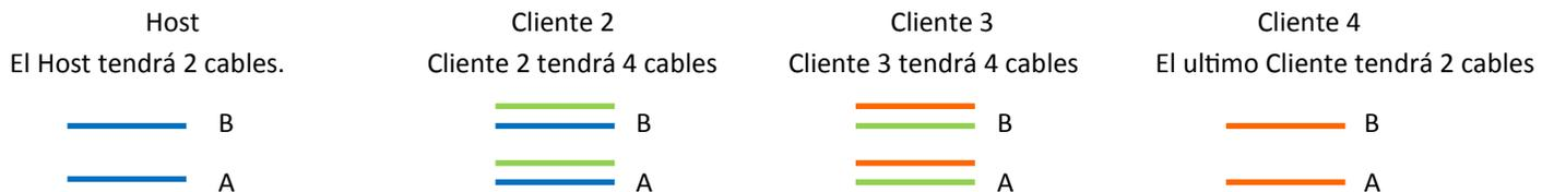
Continua hacer conexiones en cadenas hasta que la cadena esta entrelazada, alternando ranuras de la cadena hasta que llega al final de la cadena. El Host y la ultima RANURA O ESCLAVO?!?! en la cadena serán los unicos dos registros en la cadena con una sola conexión de cable.
